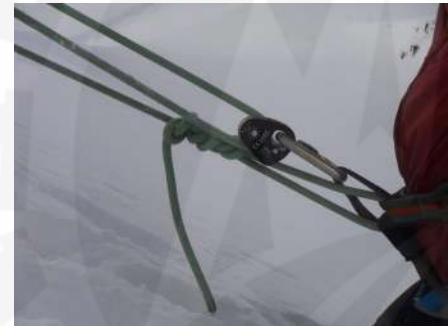
Detalle de Micro traxion en el anillo ventral del cliente
