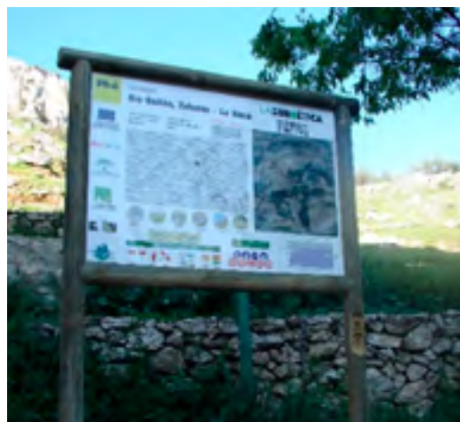
Vinilo adhesivo sobre madera con protección con protección de vinilo para exterior de laminado liso, sin protección UV. A unos meses de su colocación.
